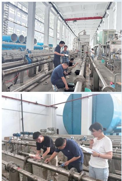
近日，水利部水文仪器及岩土工程仪器质量监督检验测试中心（简称水利部质检中心）的高精度超声流量计急需进行计量溯源和数据分析。我院环流所常州实验室的水塔法水流量标准装置具备流场好、流量稳定、气泡少等优良的流体条件，圆满完成了本次超声流量计在多管径流量点示值误差、重复性等关键指标的校准工作。
